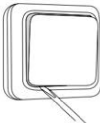
5.1. Снять клавишу путем отжатия лезвием плоской отвертки, боковой стенки клавиши.
